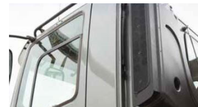
Luchtaanzuiging met cycloonfilter
