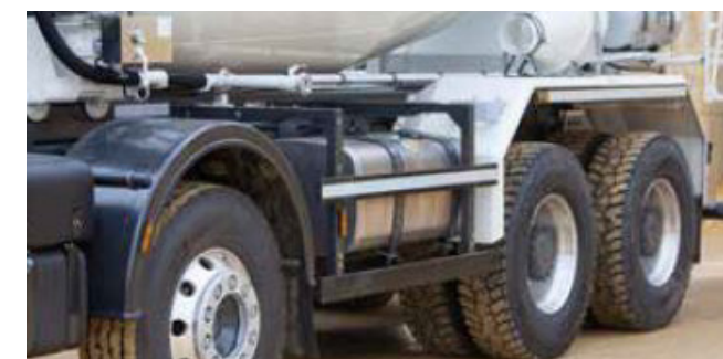
Spatborden op 2de stuuras - achterassen en zijbescherming door opbouwer
