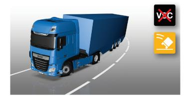
En cas de sous-virage, l'avant du véhicule glisse vers l'extérieur du virage et si l'on ne fait rien pour l'en empêcher, le véhicule quittera la route. Dans ce cas, le VSC applique les freins sur les roues situées vers l'intérieur du virage afin de rétablir la trajectoire du tracteur.
