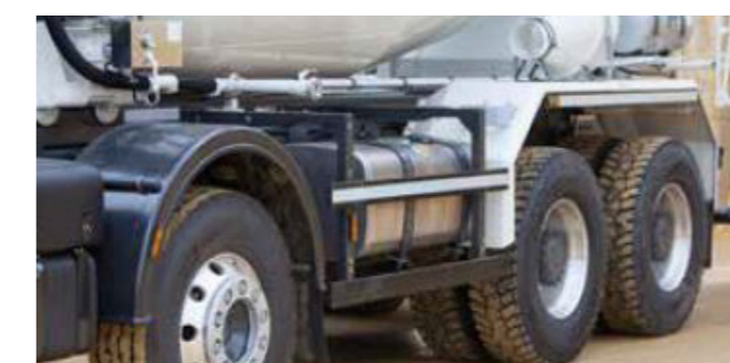
Garde-boue sur le 2ème essieu avant - essieux arrière et protection latérale par le carrossier
