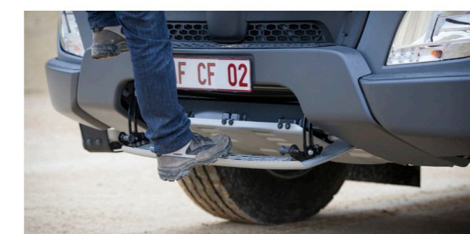
Emmarchement avant supplémentaire en combinaison avec le pare-chocs de construction
