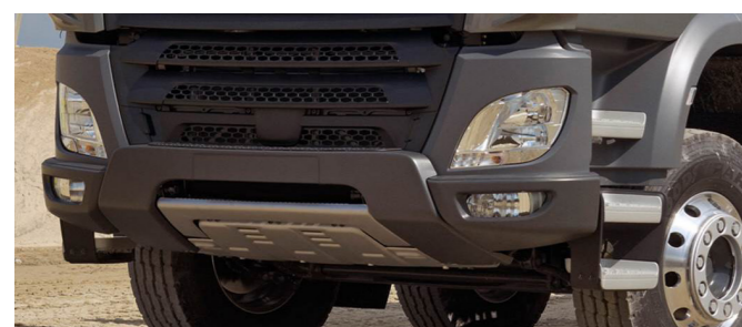
Pare choc en acier 5 mm avec protection du radiateur
