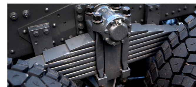
Suspension parabolique AR avec ajustement hydraulique
