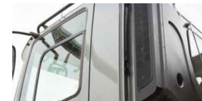
Admission d'air avec filtre cyclonique
