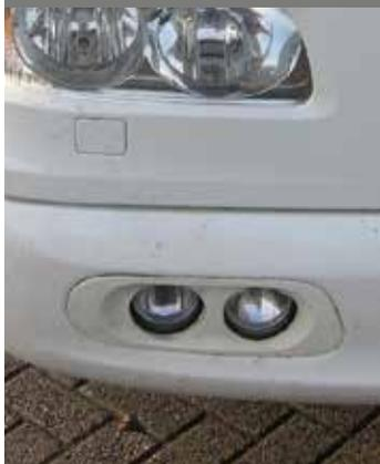
Rayures et éraflures légères qui ne provoqueront pas de déformations et relèvent de l'usure normale.
