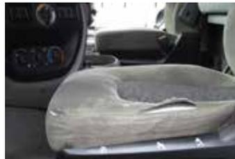
Housses de siège fissurées et déchirées en raison d'une mauvaise utilisation ou de négligences.
