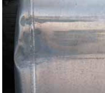
Piqûres et déformation du réservoir de carburant.
