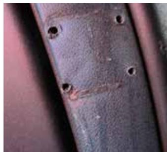
Rayures profondes ou marques sur le panneau d'instruments. Trous percés dans le tableau de bord. Plaques de protection manquantes.
