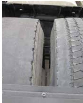
Bandes de roulement des profils irrégulières sur le même axe. Pneus rechapés sur les essieux directeurs. Coupures sur les pneus sur l'un des essieux.
