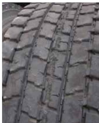
Fissures de la carcasse du pneu et piqûres dans le profil ou côtés endommagés.
