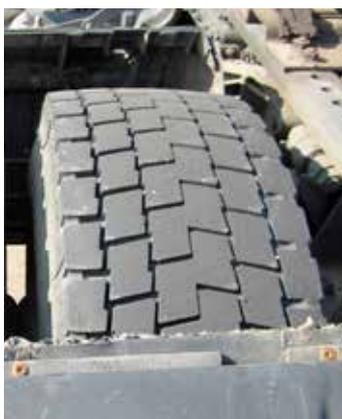
Usure normale de la carcasse du pneu et piqûres dans le profil
